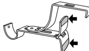
**6 /** Repositionner le support et faire pression sur la partie pivotante
